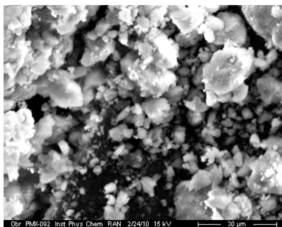
Рис. 5. Сканирующие электронные микрофотографии ОМК ГА/МЦ
