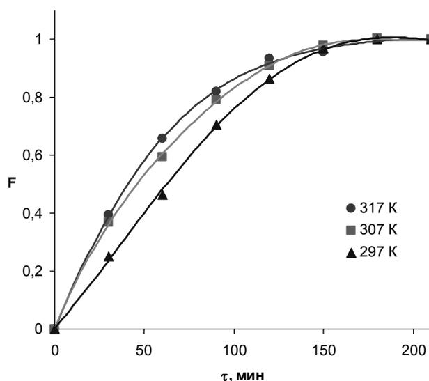
Рис. 1. Кинетические кривые сорбции формальдегида при различных температурах
