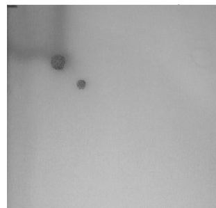
Рис. 5. Снимок пластины после двумерного проявления. аналит: ( \pm )карведилол; подвижная фаза МеСН/МеОН (7,5:2) + NH 3 ·Н 2 О (0,2мл); ТСХ-пластина, модифицированная L-лизинном (0,5%).
