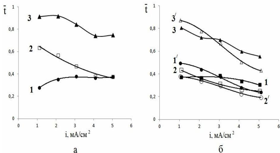
Рис. 2. Зависимости чисел переноса противоионов ( $\bar{t}$ ) от плотности тока ( $i$ ) при электродиализе смесей Na<sub>2</sub>SO<sub>4</sub> + NaCl (а); Na<sub>2</sub>SO<sub>4</sub> + NaCl + пектин и Na<sub>2</sub>SO<sub>4</sub> + NaCl + пектат (б). 1 – хлор-ионы, 2 – сульфат-ионы, 3 – их сумма. Данные для пектатсодержащих смесей обозначены штрихами
