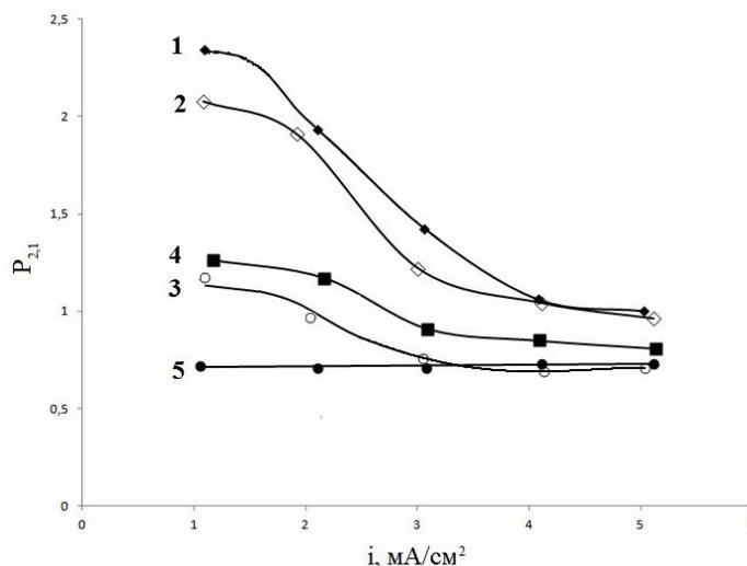
Рис. 4. Зависимость относительных чисел переноса ( $P_{2,1}$ ) от плотности тока ( $i$ ) при электродиализе смесей: 1 – Na<sub>2</sub>SO<sub>4</sub> + NaCl, 2 – H<sub>2</sub>SO<sub>4</sub> + HCl, 3 – Na<sub>2</sub>SO<sub>4</sub> + NaCl + пектин, 4 – H<sub>2</sub>SO<sub>4</sub> + HCl + пектин, 5 – Na<sub>2</sub>SO<sub>4</sub> + NaCl + пектат
