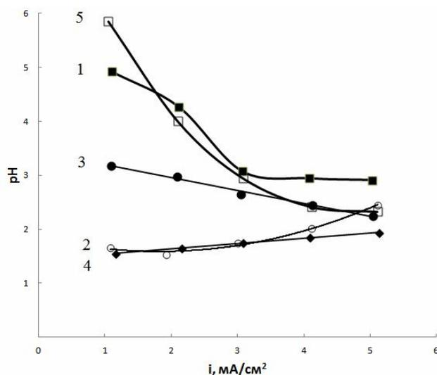
Рис. 3. Зависимости рН раствора секции деионизации от плотности тока ( $i$ ) при электродиализе смесей: 1 –  $\text{Na}_2\text{SO}_4 + \text{NaCl}$ , 2 –  $\text{H}_2\text{SO}_4 + \text{HCl}$ , 3 –  $\text{Na}_2\text{SO}_4 + \text{NaCl} + \text{пектин}$ , 4 –  $\text{H}_2\text{SO}_4 + \text{HCl} + \text{пектин}$ , 5 –  $\text{Na}_2\text{SO}_4 + \text{NaCl} + \text{пектат}$
