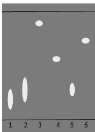
Рис. 1. Вид хроматограммы стандартных образцов органических кислот в системе №4: 1 – щавелевая кислота; 2 – лимонная кислота; 3 – янтарная кислота; 4 – аскорбиновая кислота; 5 – винная кислота; 6 – яблочная кислота. Объем пробы 5 мкл
