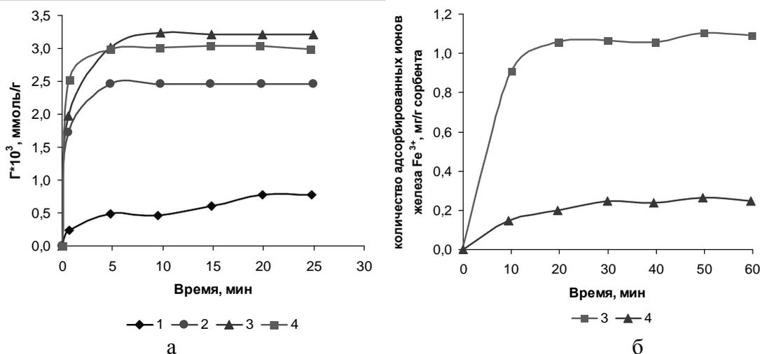
Рис. 1. Сорбция метиленового голубого (а) и ионов железа Fe<sup>3+</sup> (б) экспериментальными сорбентами: 1 – шелуха кофе, 2 – продукты пиролиза шелухи кофе, 3 – ВШК-1, 4 - ВТ6
